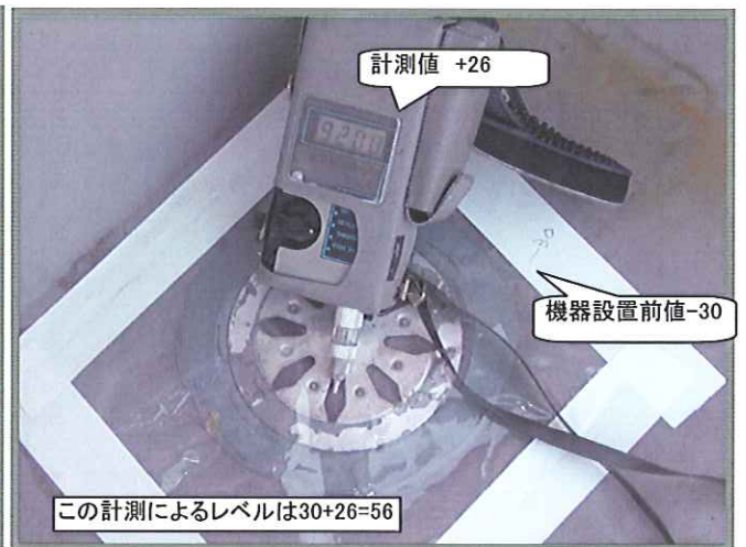
香りセンサーによる調査状況 計測値は 56レベルを示している。
